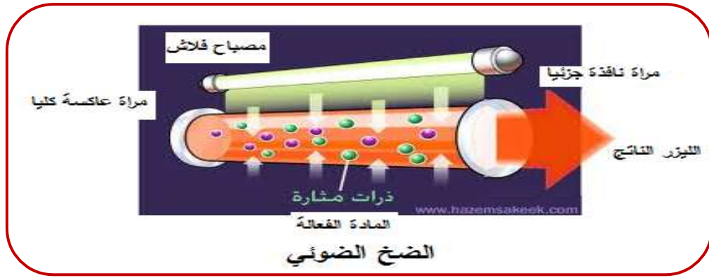
الشكل (II-2) مكونات ليزر الياقوت [26]
