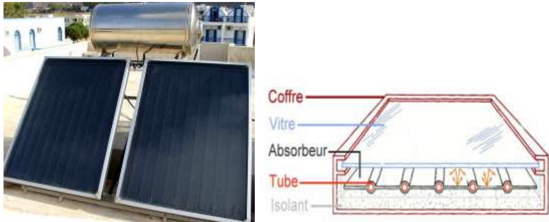
Figure(III.8): Capteur solaire pour le chauffage d'eau.
