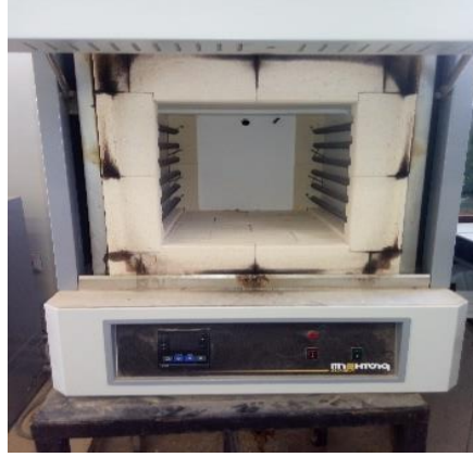
الشكل (V - 3): جهاز الفرن المستعمل في الحرق
