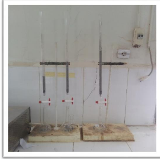
الشكل ( V - 18 ) : إمتزاز شوارد النيكل بالرمل المغلف بالغرافين
