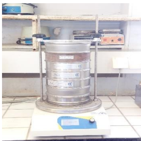
الشكل (V - 2): جهاز التصنيف الحبيبي
