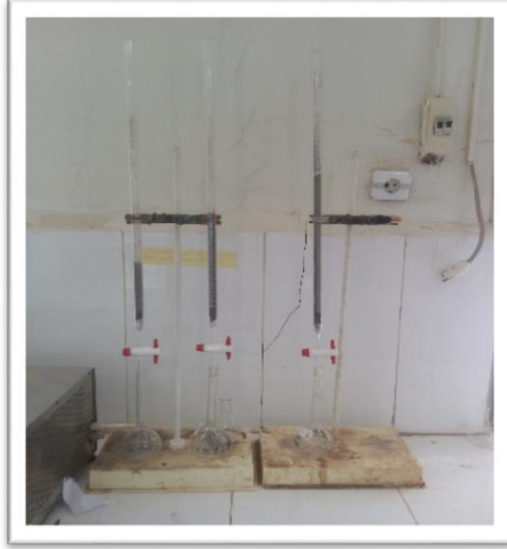
الشكل (V - 21): إمتزاز شوارد الرصاص بالرمل المغلف بالغرافين
