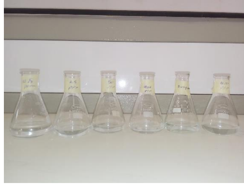
الشكل (V - 14): المحاليل القياسية لشوارد النيكل
