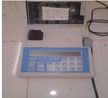
الشكل (V - 4): جهاز مطيافية الأشعة المرئية وفوق البنفسجية المستعمل
