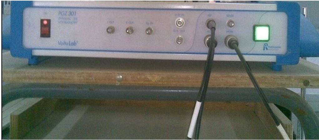
الشكل (6-IV): جهاز Potentionostat- Galvanostat من نوع PGZ 301
