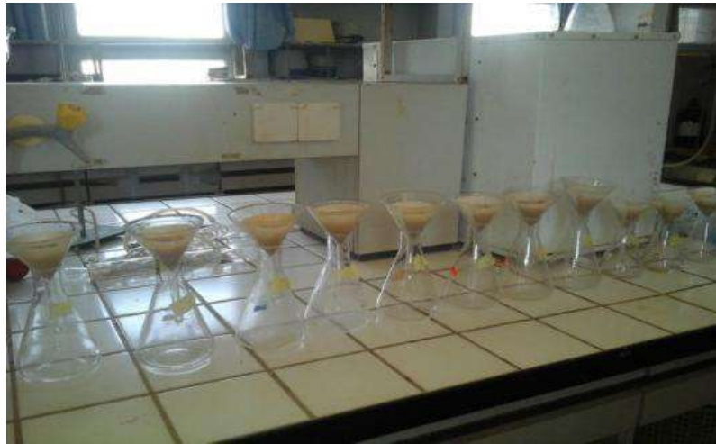
Photo 3: Préparation d'extrait de sol 1/2.5 et mesure de pH à l'aide d'un pH-mètre.
