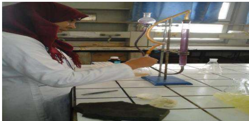
Photo 4:mesure de calcaire total
