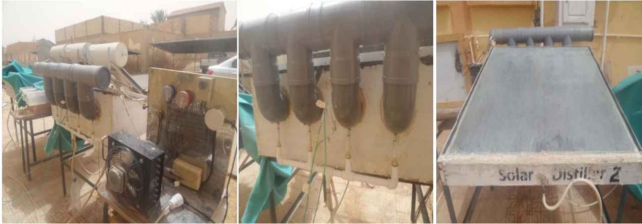
الشكل (18-IV): صورة توضح كيفية ربط مبخر المضخة بمكثف المقطر في مجموعة التجارب الثانية
