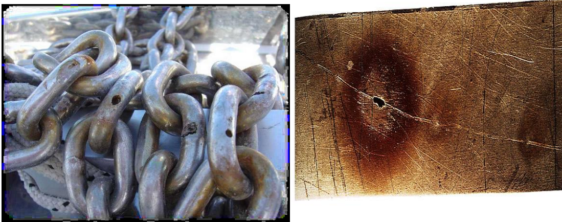
Figure 1.4 corrosion par piques [4], [6]
