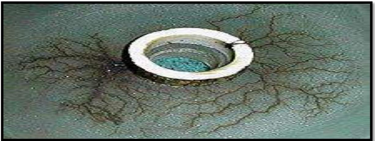
**Figure I.4:**Décharges partielles en surface, ayant pris la forme d'une arborescence d'eau
