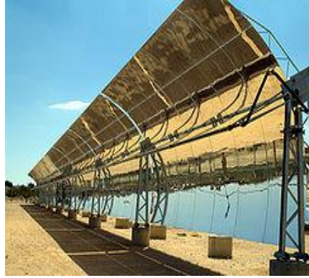
الشكل (1-2)-الجمع الشمسي الاسطواناني القطع مكافئ ( PTC )
