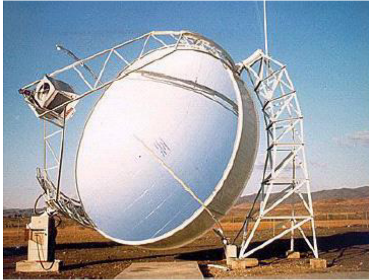
الشكل (2-11) : المجمع الشمسي المقعر ذو البؤرة النقطية
