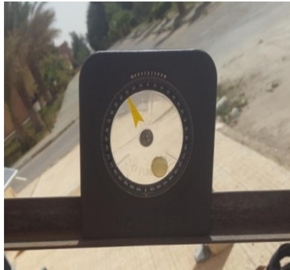
شكل (4-2): الأجهزة المستعملة في تحديد إتجاه وزاوية ميل الألواح الشمسية.
