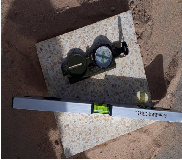
شكل (4-2): الأجهزة المستعملة في تحديد إتجاه وزاوية ميل الألواح الشمسية.
