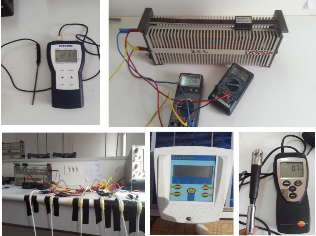
شكل (3-4): الأجهزة المستعملة لقياس الأحوال الجوية والقيم الكهربائية.
