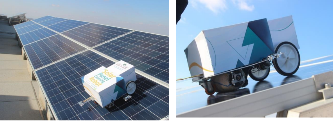
الشكل (3-4) التنظيف الآلي للألواح الشمسية .
