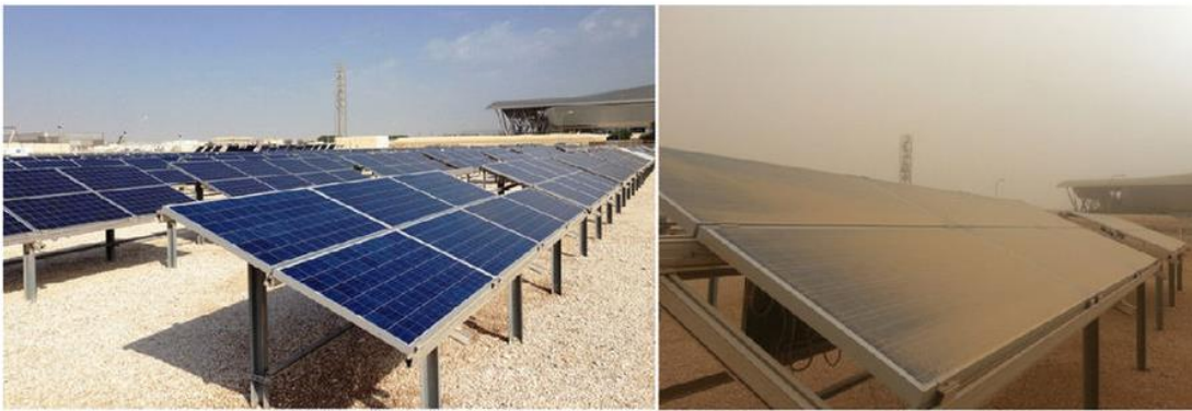
شكل (3-2) : الألواح قبل وبعد تراكم الغبار في بحث إبراهيم عيسى [ 21 ]
