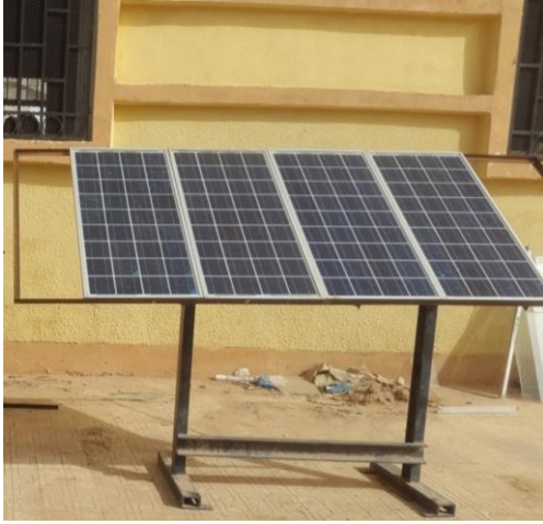
شكل (4-1): الألواح الأربعة مثبتة على الهيكل الحديدي المعدل خصيصاً لهم.
