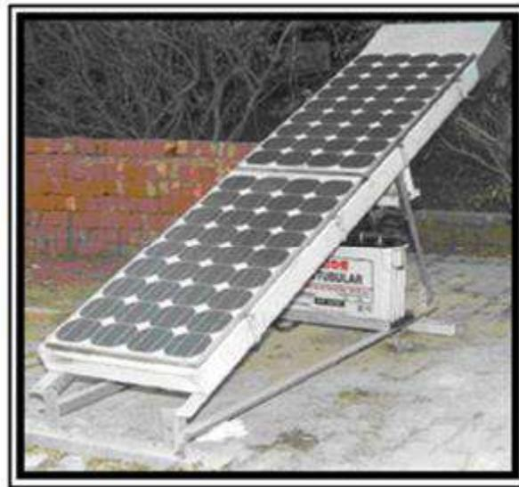
**Figure I.4:** Banc d'essai du capteur solaire PV/T hybride à air
