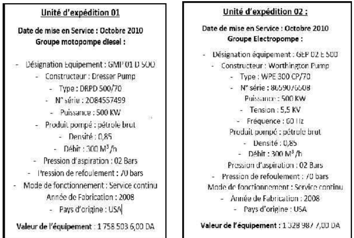
Figure III.3.3. Représente les caractéristiques de GMP et GEP
