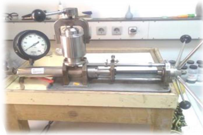
Figure 18 : Pompe volumétrique à mercure (CRD 2018).
