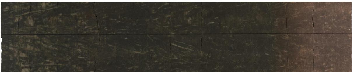
Figure 13 : Photographier sous 360° de la carotte N°5, profondeur 3266m.
