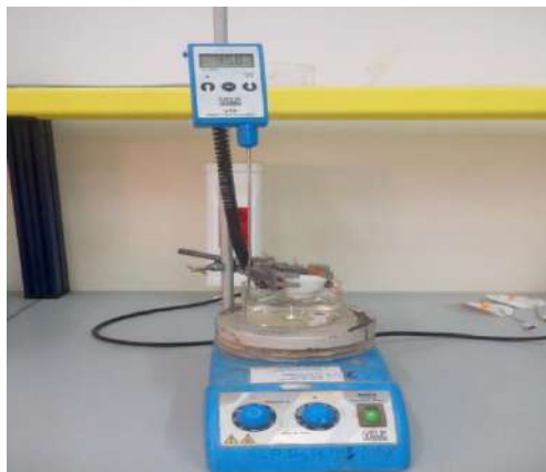
Figure 20: montage du chauffage de la paraffine
