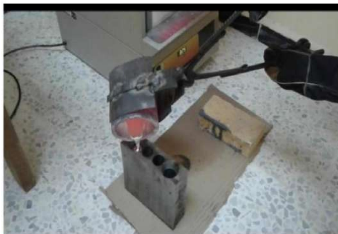
الشكل 1-3: صورة توضح عملية صب الخليط المنصهر في القوالب
