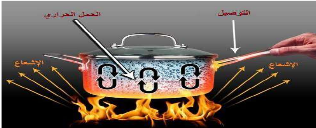
الشكل 2-1 : صورة توضح طرق انتقال الحرارة
