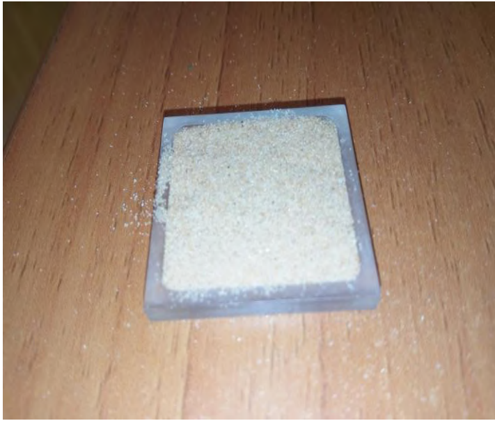
الشكل (III-2): صورة فوتوغرافية لحامل العينة في جهاز الأشعة السينية.
