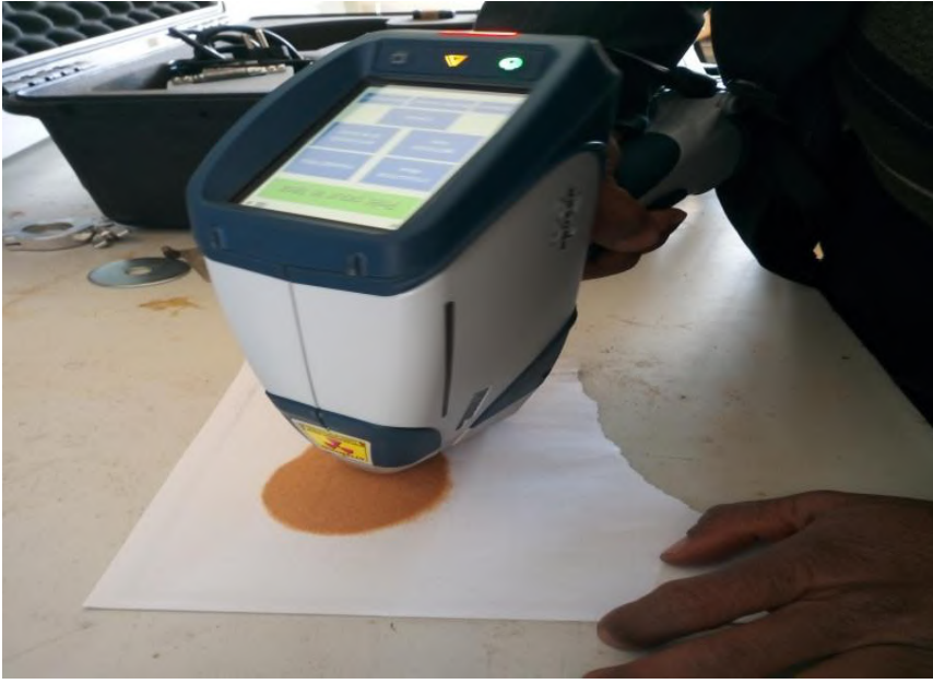
الشكل (III-7): طريقة عمل جهاز الفلورة.
