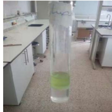
الصورة (1) : إختبار نقاوة زيت الصبار
