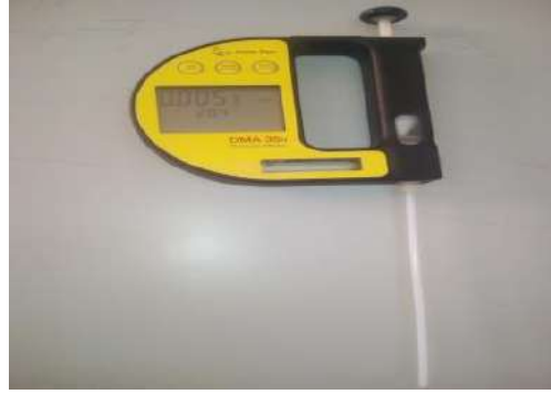
الصورة (3) : جهاز قياس الكثافة النوعية densitometer
