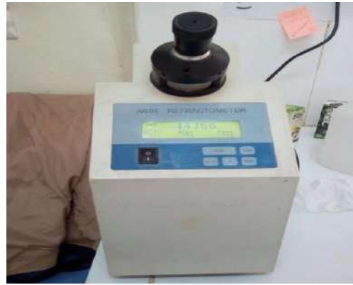
الصورة (4) : جهاز قياس قرينة الانكسار Refractometer
