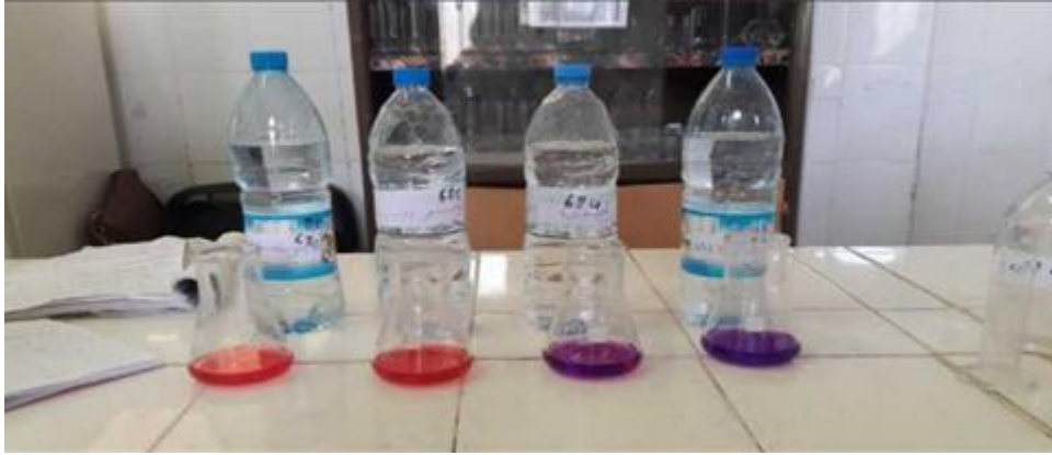
الشكل رقم (12) : يمثل صورة للعينات قبل و بعد معايرة الكالسيوم
