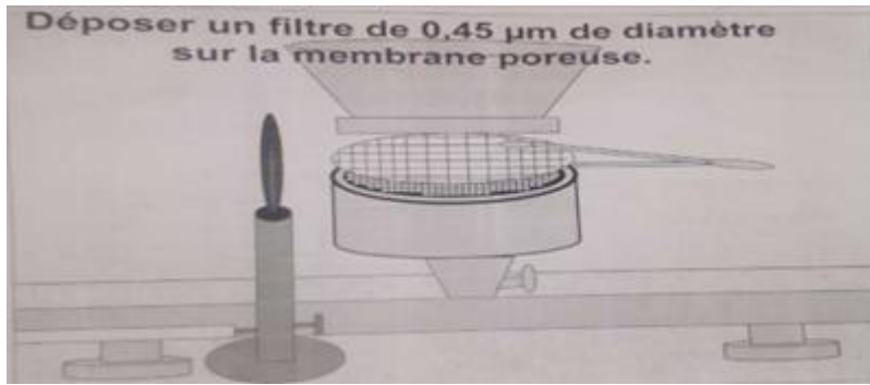
الشكل رقم (20): يمثل صورة لطريقة وضع الفلتر الورقي فوق الداعمة المسامية
