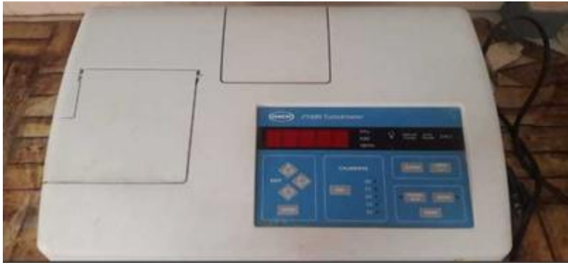
الشكل رقم (10): يمثل صورة لجهاز قياس العكارة
