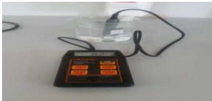
الشكل رقم (9): يمثل صورة لجهاز قياس الناقلية
