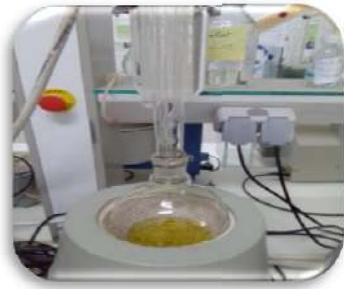
الاستخلاص بجهاز سوكسلي
