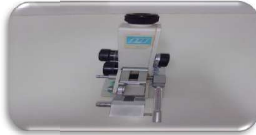
الصورة 4-V: جهاز Refractomètre
