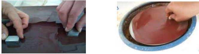
الشكل(9-II):طريقة الصقل يدوي الشكل (10-II):طريقة الصقل الميكانيكي
