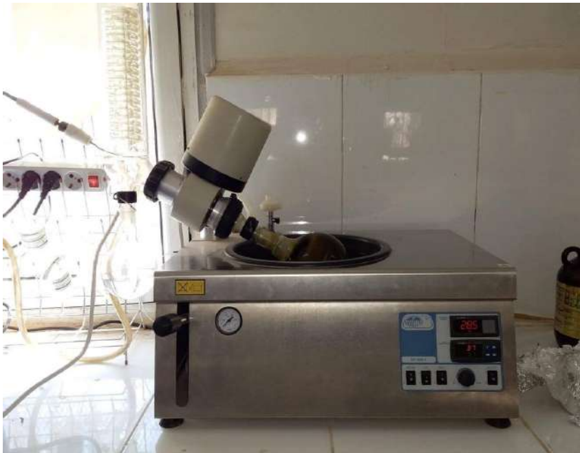
الصورة (3_II): جهاز التبخير الدوراني المستعمل في عملية الاستخلاص
