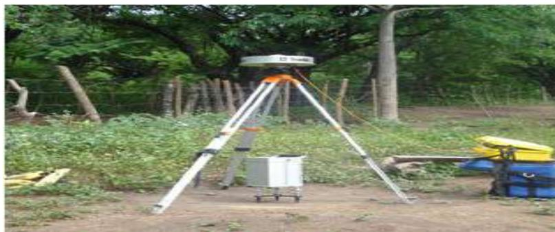
**Fig III.6** Gravimètre terrestre [21]
