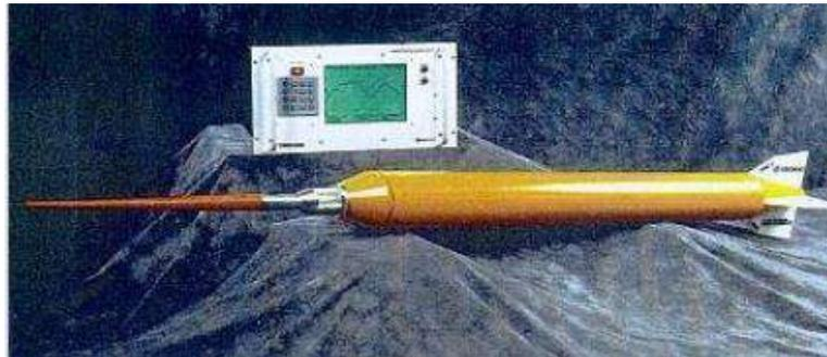
Fig III.7 Gravimètre marin de surface
