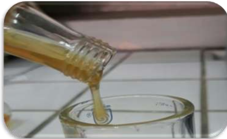
Figure (22): Aspect visqueuse de milieu liquide MRSs après production EPS par souche Ln. mesenteroides subsp mesenteroides
