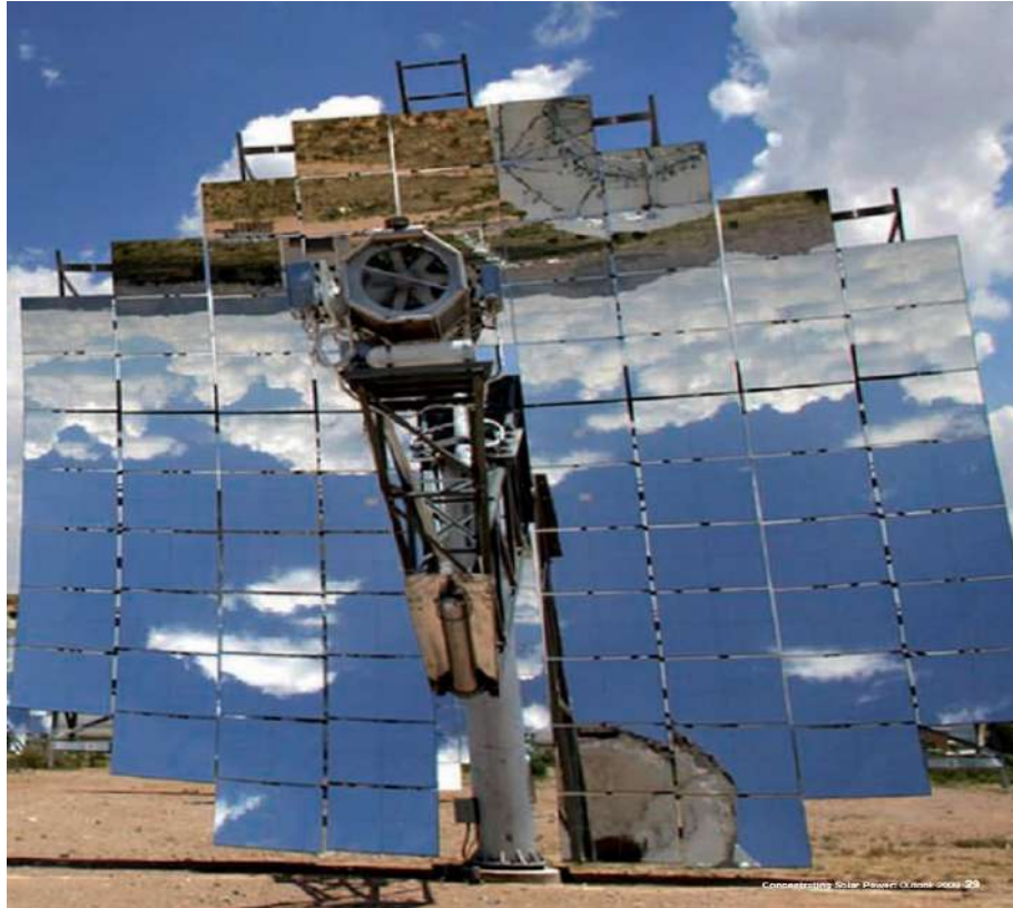
Figure.2.4 : Paraboles Solaires Dish Stirling[15].
