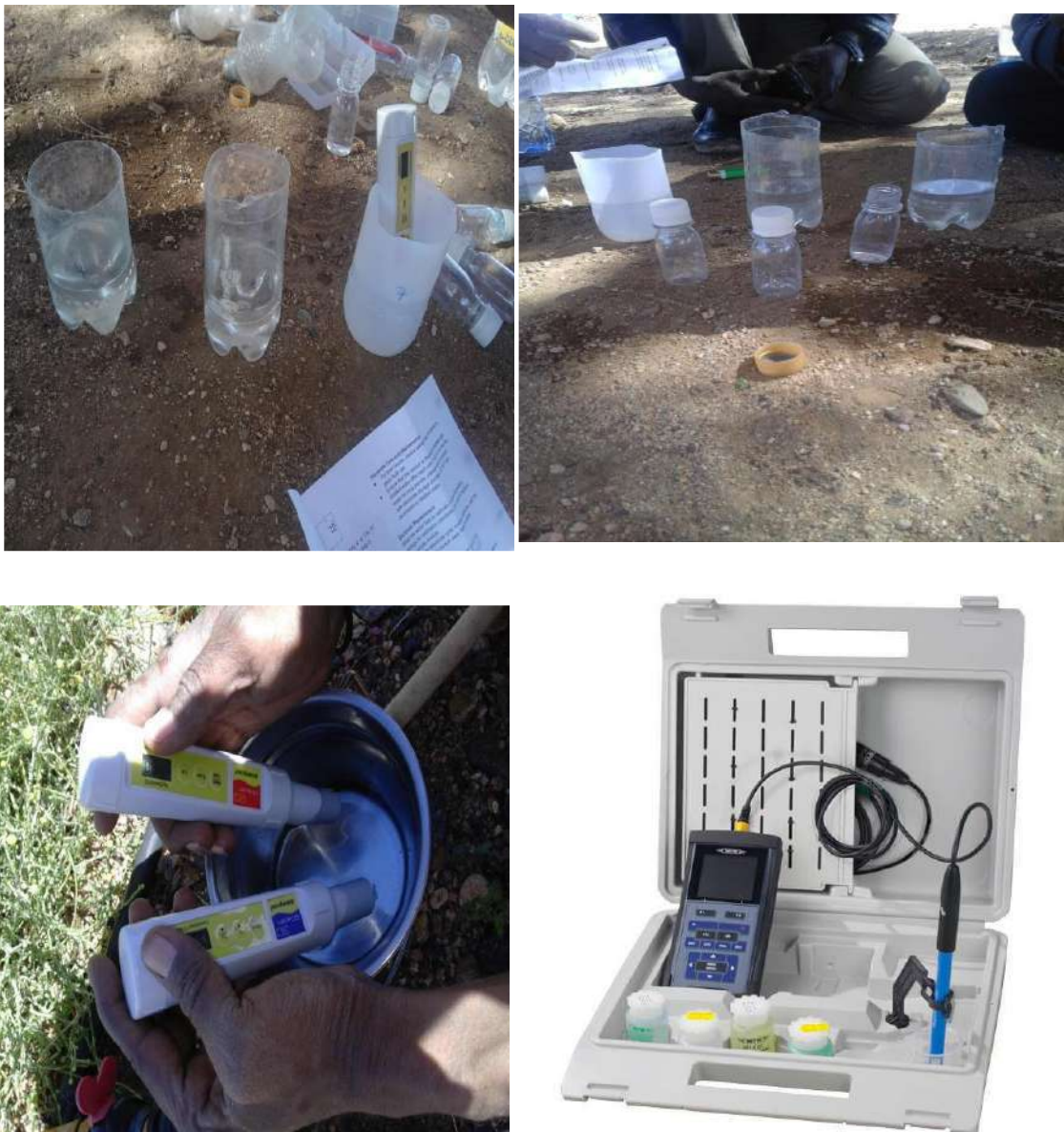
Figure(23) : Le matériel utilisé pour mesurer les paramètres pH, Conductivité sur terrain
