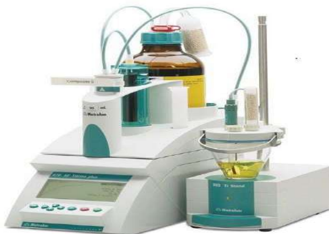
Figure(26) : les dosages des Chlorures sont réalisés par Titrino 848 de marque Metrohm II.
