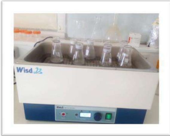
الصورة (ب.3): وضع العينات في الحمام المائي درجة حرارة (45-40)
