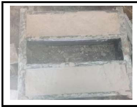
صورة 9.III: توضح عينات بحجم (7 × 7 × 28) سم
