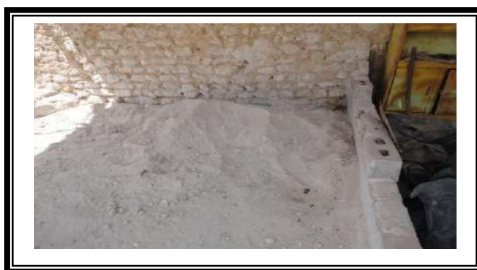
الصورة 5.I. : تمشمت جاهزة للإستعمال
