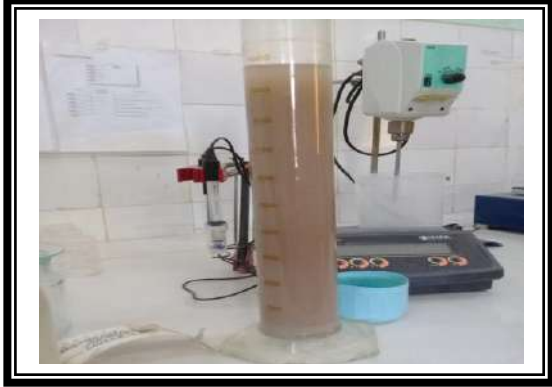
الصورة 6.II: صور لتجربة التحليل الحبيبي و الترسيب
