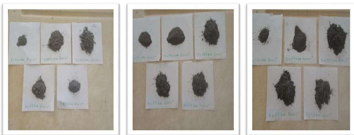
Figure (III.8) :les différentes fractions des diamètres contenant dans des cendres .
