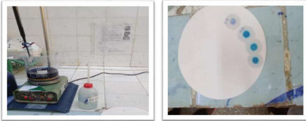
Figure (III.5) : Exécution de l'essai au bleu de méthylène.
