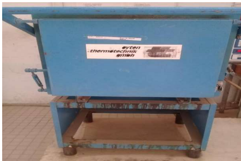
Photo16 : Four de grande capacité.
