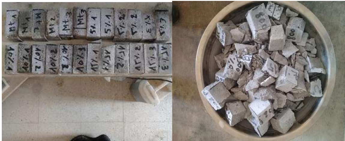
Photo 10: Éprouvette d'un mortier après l'essai de flexion et compression.
