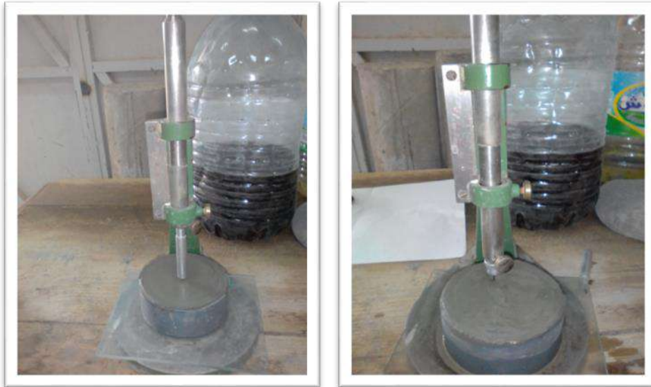
Figure (III.13) : début prise de ciment.
