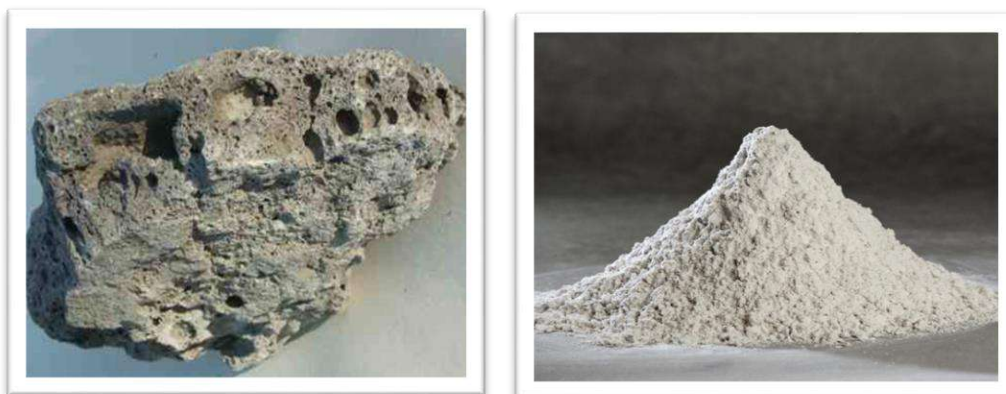
Figure (I.5) : Le laitier de haut fourneau (site de lerm).
