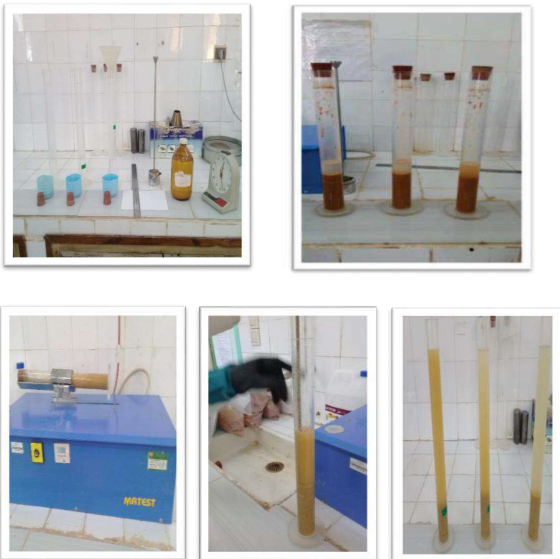
Figure (III.4) : Appareillage et les éprouvette de l'équivalent de sable normalisé.
