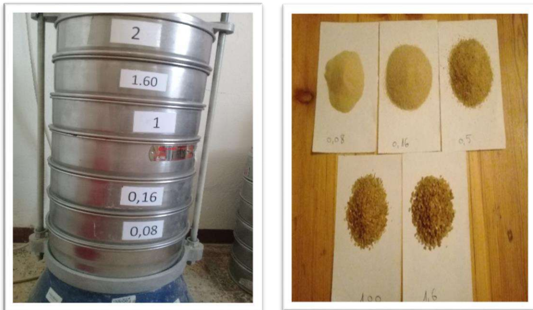
Figure (III.1) : la différente fraction contenant dans un sable normalisé.
