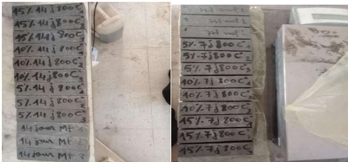
Photo 9 : Éprouvette d'un mortier et éprouvette d'un mortier avec la cendre.
