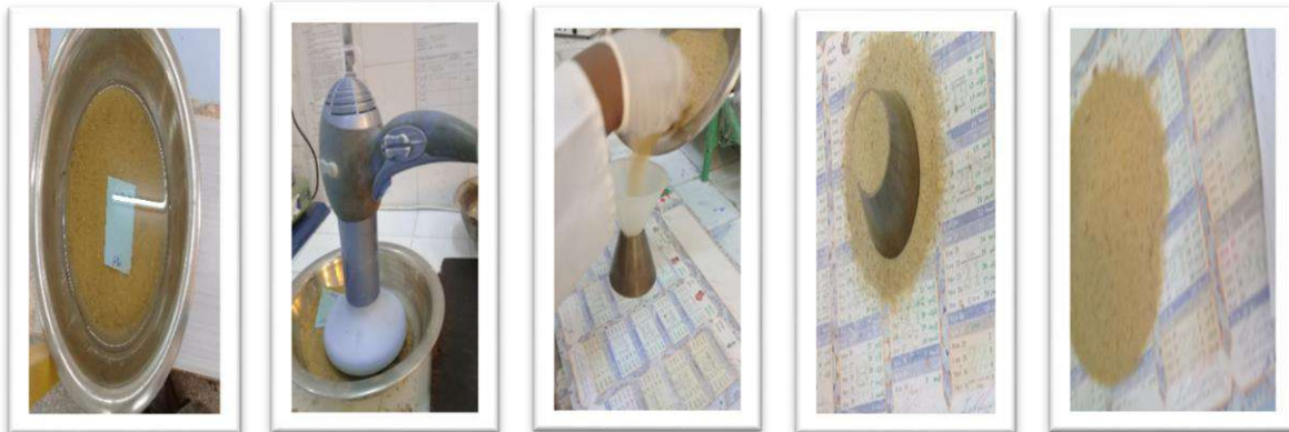
Figure (III.3) : les étapes d'essai d'absorption d'eau du sable.
