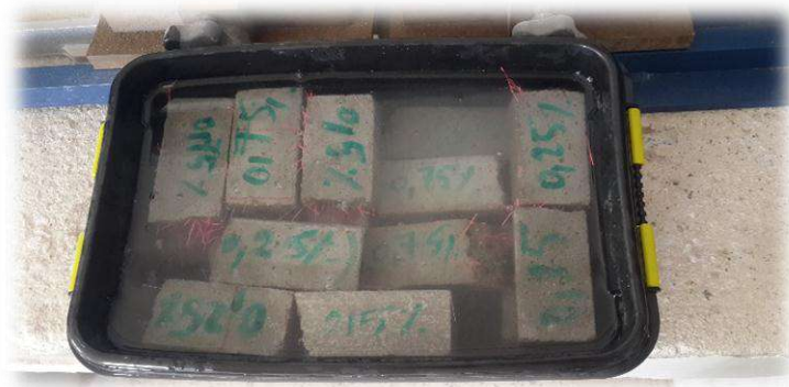
Photo II.8. Conservation des éprouvettes dans l'eau pendant 24h
