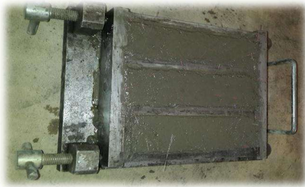
Photo II.7. Remplissage des moules 4x4x16.
