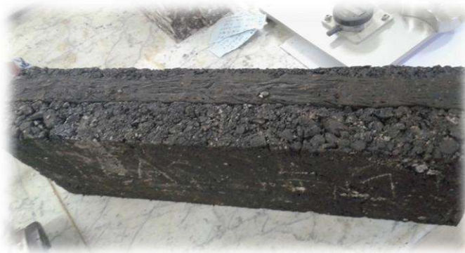
Figure V.14. Une plaque renforcée par géogrille.
