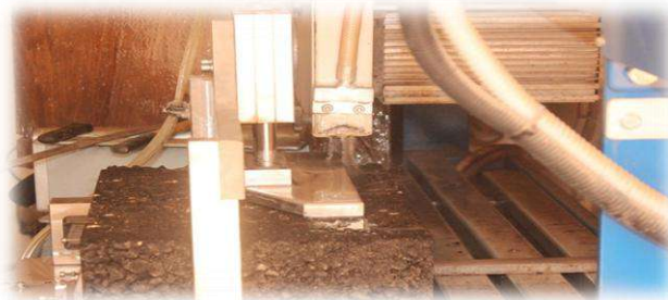
Figure V.15. Opération de coupage d'une plaque de fatigue.
