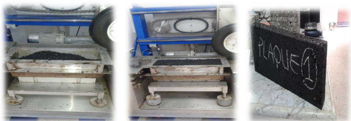
d) Préparation d'enrobé Sur la plaque
