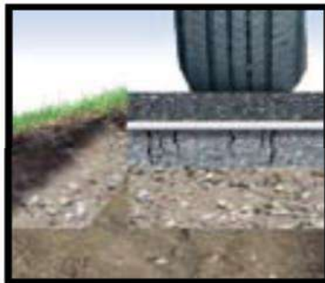
Figure. II.5. Rénovation de l'asphalte [Fibertex, CHAFI Samir; 2008].
