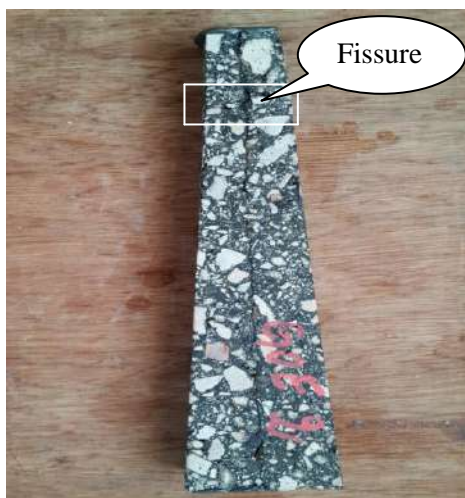
Figure V.22. Fissuration d'éprouvette renforcé par géogrille
