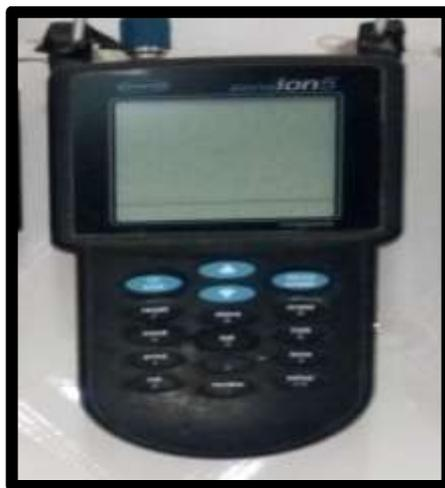
الصورة رقم IV 02 : جهاز قياس الناقلية
