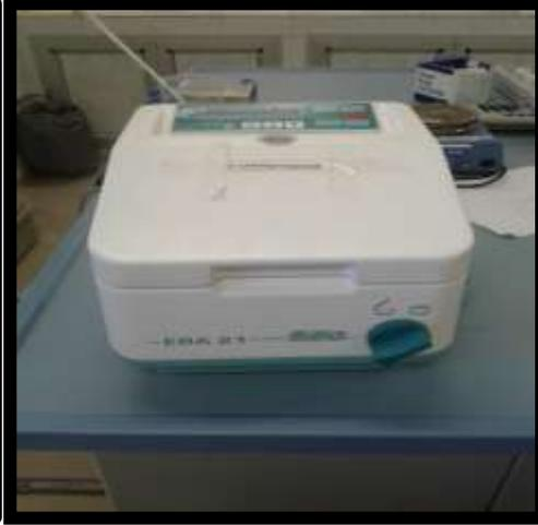
الصورة رقم IV 04 : جهاز الطرد المركزي
