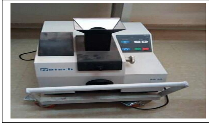
الشكل II-5: الجهاز المستعمل في طحن عينة الصخر.
