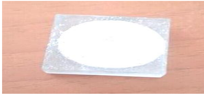
الشكل II-12: نموذج لعينة تم تحضيرها للقياس XRD
