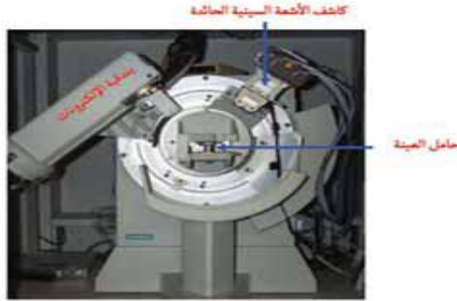
الشكل II-9: جهاز حيود الأشعة في العينات الصلبة على هيئة مسحوق [15]
