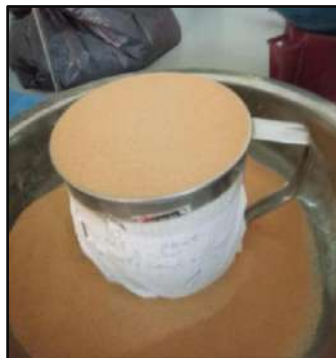
Photo II.5. Essai de la masse volumique apparente
