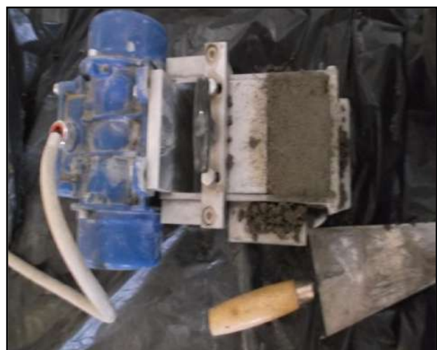
Fig. II.5. Principe de fonctionnement du Maniabilimètre LCPC. [26]
