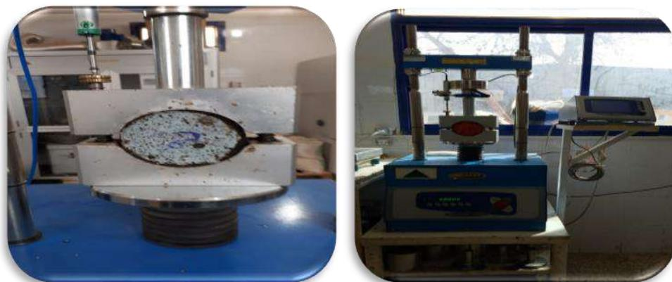
PHOTO IV.1. Appareillage et essai Marshall.
