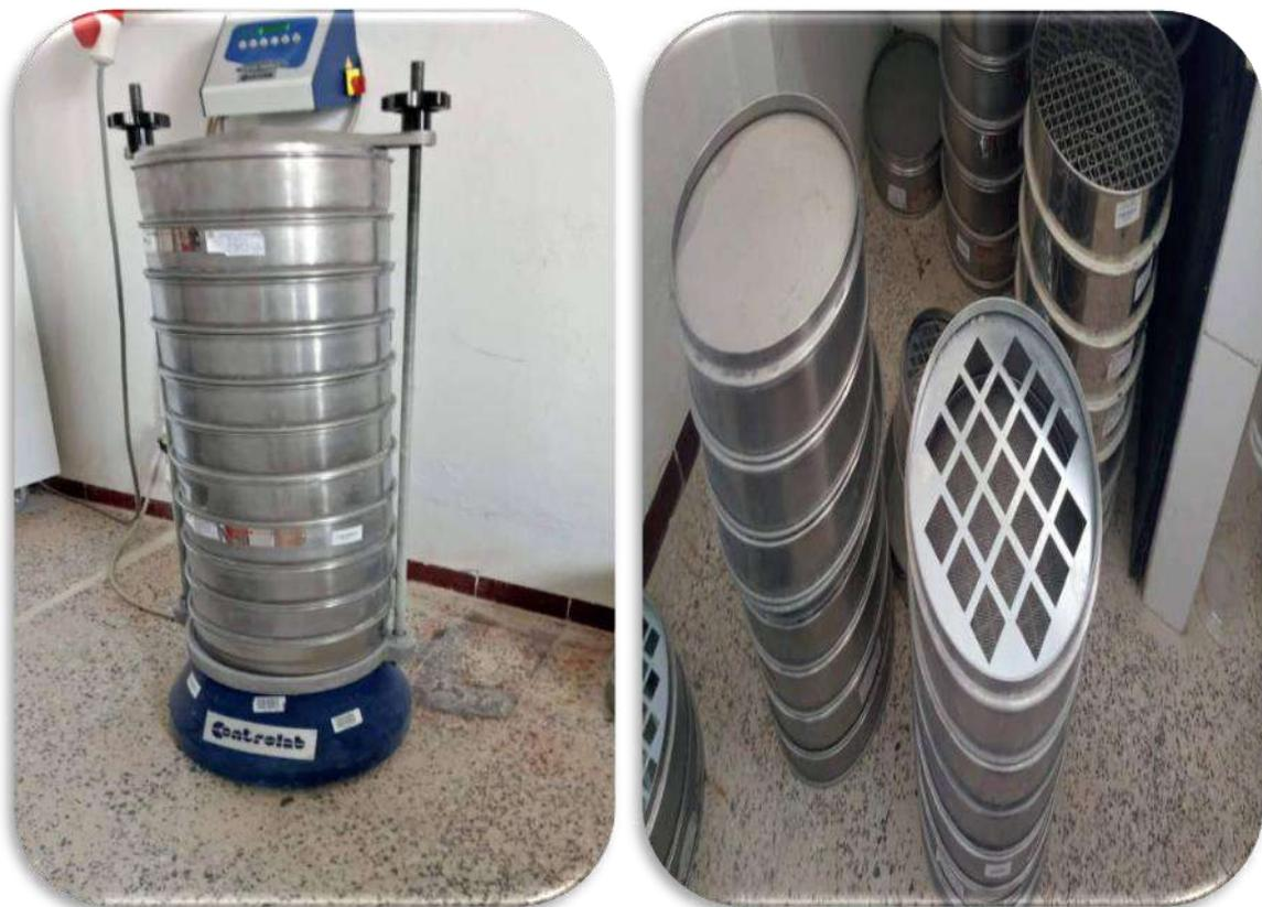
PHOTO III.1. Équipements pour analyse granulométrique.
