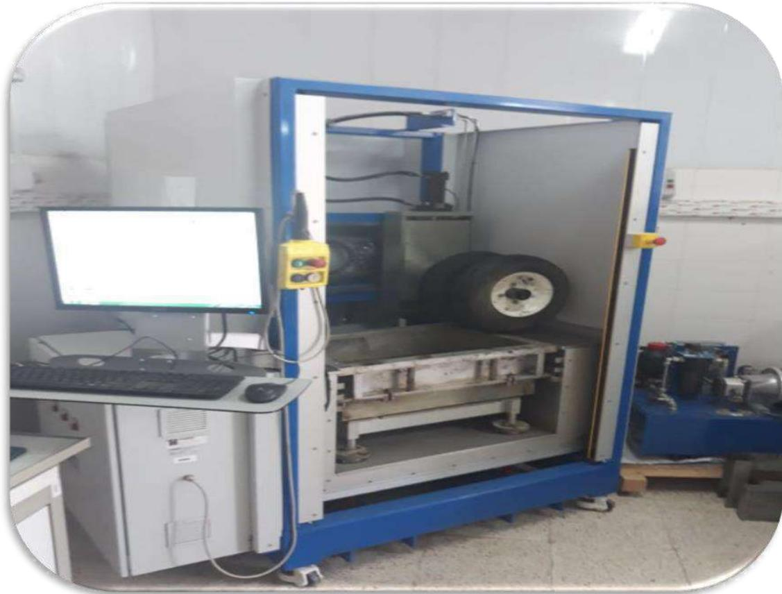
**PHOTO V.3.** Compacteur de plaque à roue EN 12697-33/NA 5369.
