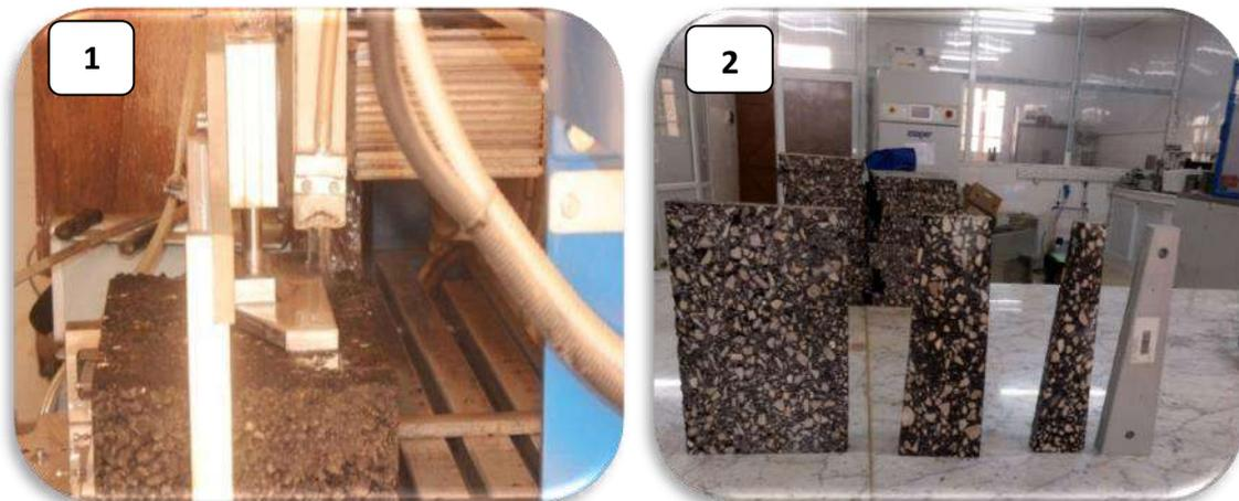
**PHOTO V.5.** Etapes de formulation de éprouvettes trapézoïdales.
