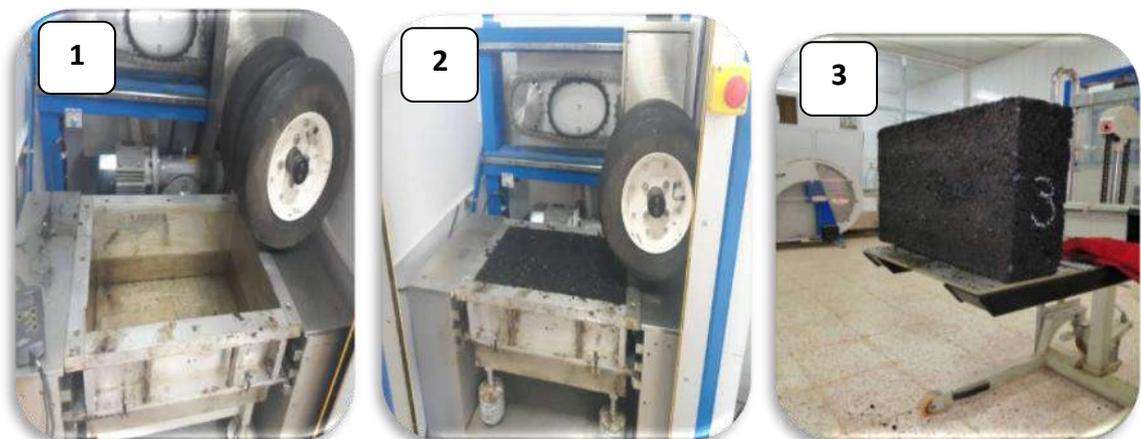
**PHOTO V.4.** Préparation du moule d'asphalt.
