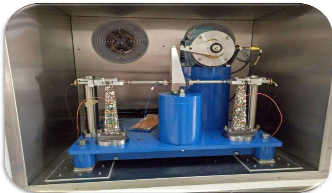
**PHOTO IV.7.** Appareil de l'essai de flexion 2 points de l'intérieur.
