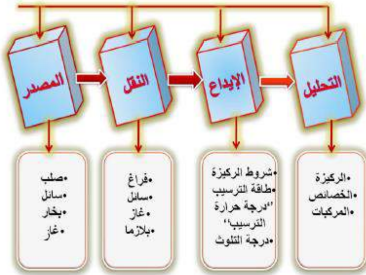
الشكل (1.III): رسم تخطيطي يوضح خطوات ترسيب الأغشية الرقيقة [2]
