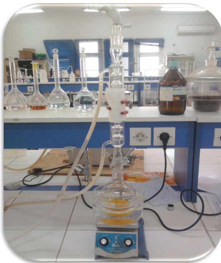
Figure n°21: le montage de la synthèse de laSalicylidène p-toluidine
