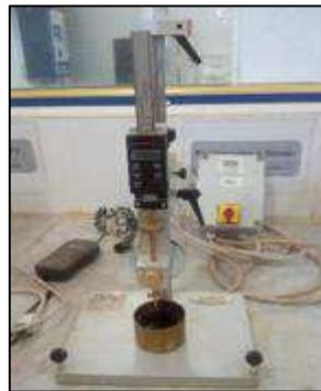
**Photo (V.2) :** Exemple de l'appareil de pénétrabilité + l'échantillon (LTPS Ghardaïa)
