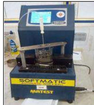
**Photo (V.5) :** Exemple de l'appareil de TBA + l'échantillon (LTPS Ghardaïa)
