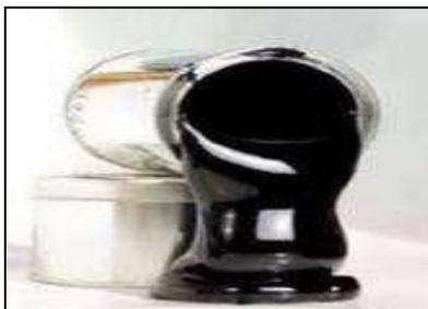
**Figure (IV.1) :** Bitume de classe 40/50
