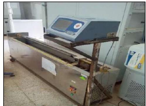
**Photo (V.8) :** Exemple de l'appareil de ductilité (LTPS Ghardaïa)
