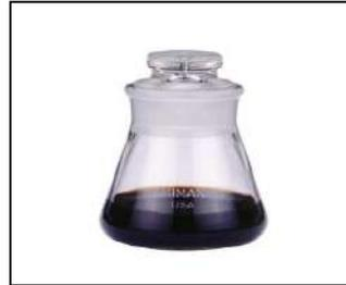
**Figure (I.6) :** Pycnomètre + bitume
