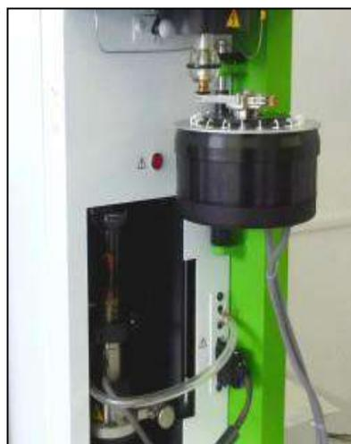
Figure (II.12) : Appareillage de TGA [23]
