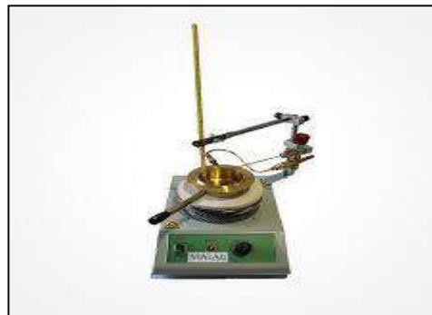
**Figure (I.7) :** Appareil de l'essai point d'éclair et de feu
