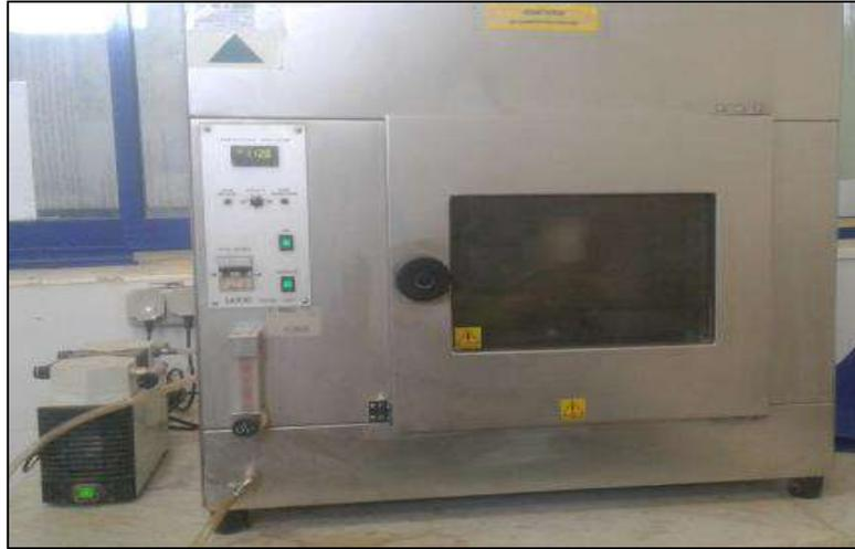
**Photo (I.1) :** Appareil de l'essai RTFOT (LTPS Ghardaia)
