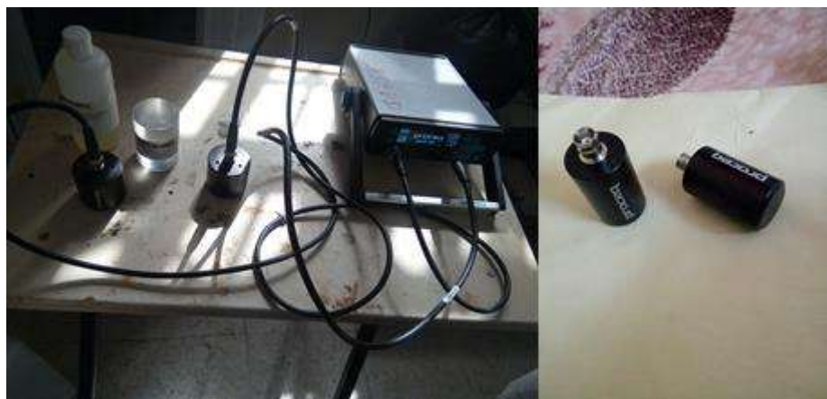
Figure III.5 : Appareillage de l'essai de l'ultrason.
