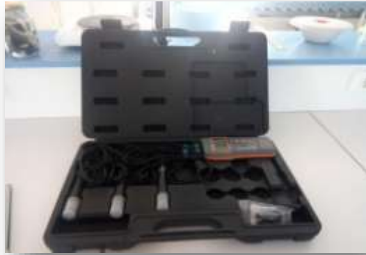
Figure 06 : Multi paramètres de terrain pour la mesure des paramètres physico-chimique.
