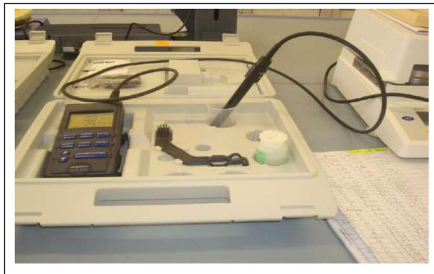
Figure n° 15 : Mesure de la conductivité électrique, salinité et température
