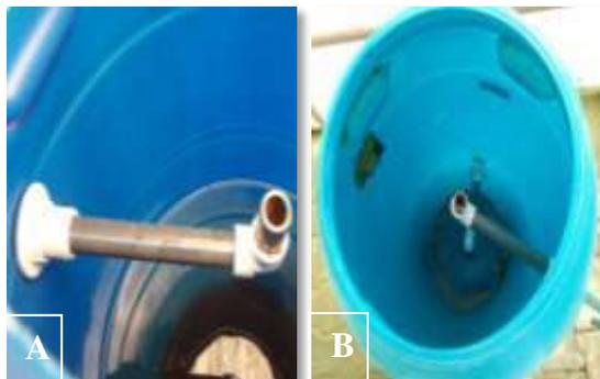
**Figure 38:** La sortie d'eau de séparateur mécanique (A et B).
