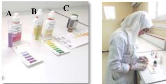
**Figure 22:** Dosage des sels nutritifs par la méthode colorimétrique visuel (A: nitrite. B: ammonium. Et C: nitrate).
