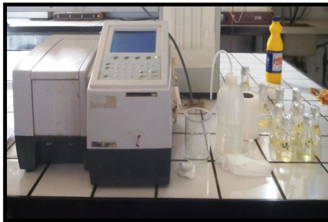
Photo 07 : Mesure de la densité optique par spectrophotométrie
