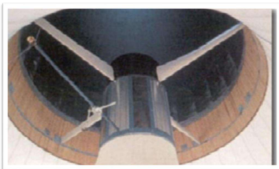
Figure I.4 : Turbine pour Cheminée Solaire de large diamètre [03]
