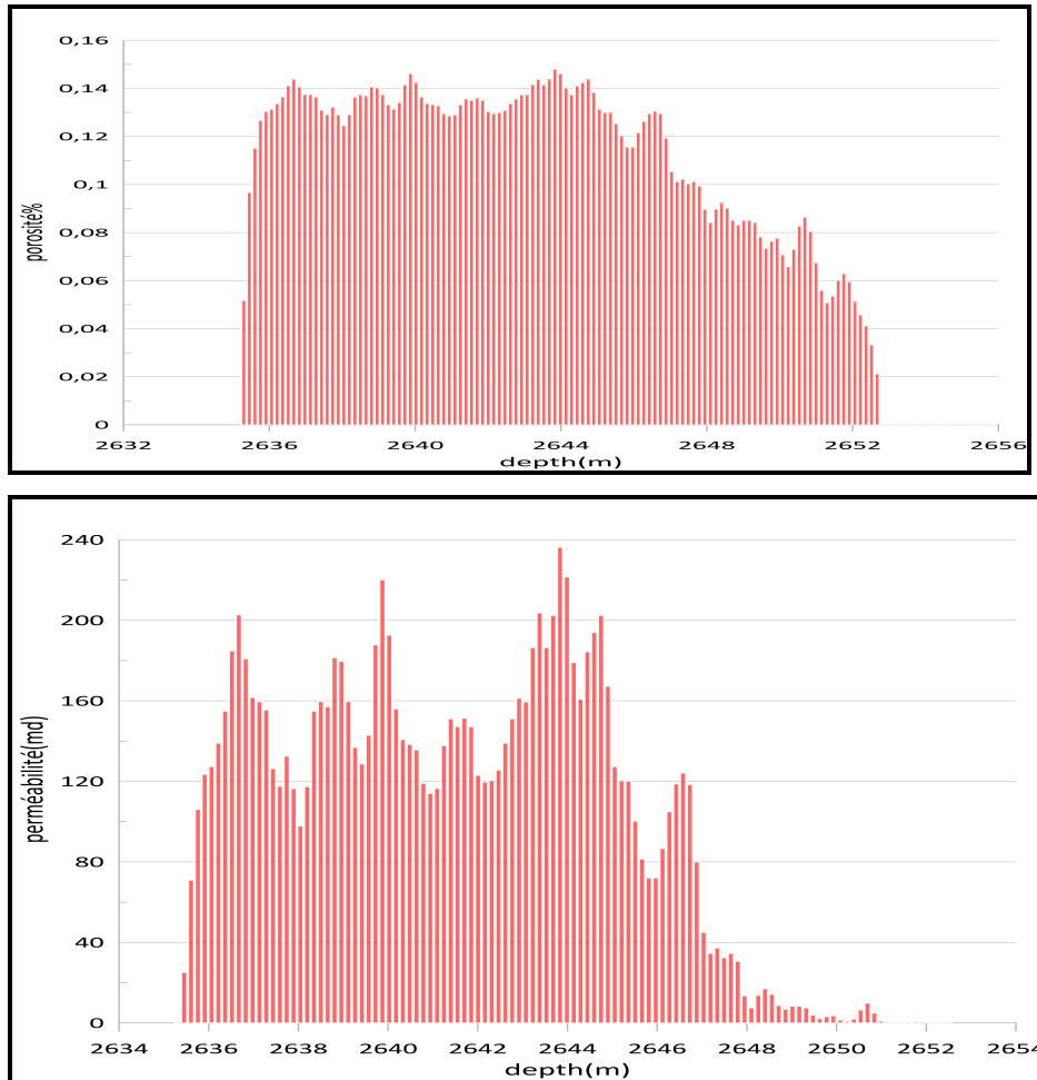
Fig. 31: l'évolution verticale la porosité et la perméabilité (de diagraphique) de réservoir (F3) AL-88
