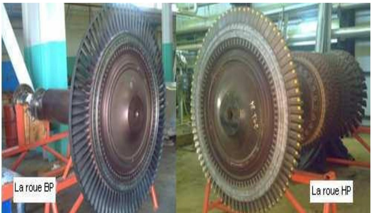
**Figure II .9 Rotor de la turbine HP et BP**
