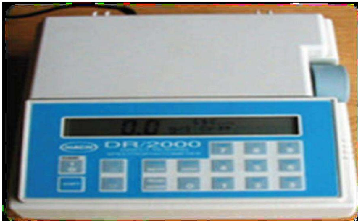
Figure IV.2: Spectrophotomètre DR 2000.
