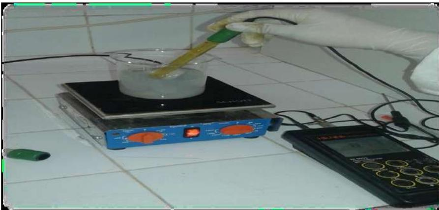
Figure IV.6 : Préparation de silice activée
