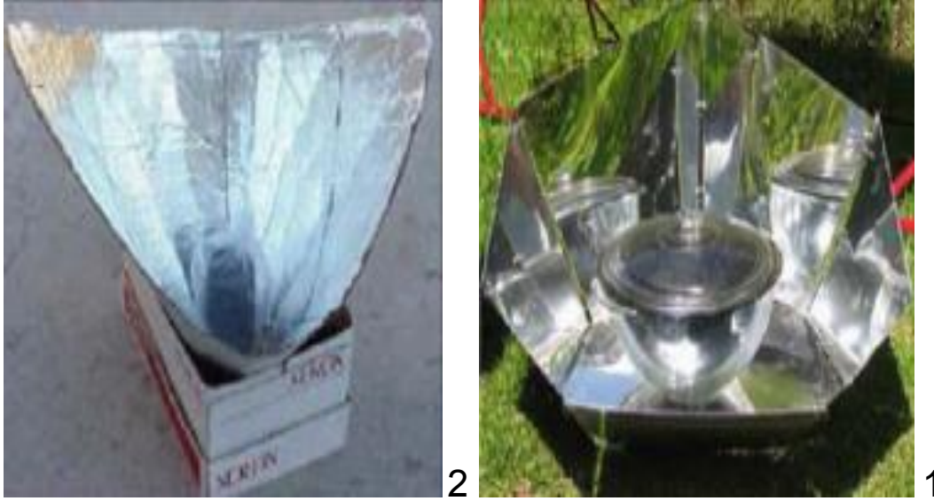
الشكل (3-9): المواقد الشمسية التي تركز الضوء على: (1) طبخ الألواح، (2) طبخ قمع. [18]
