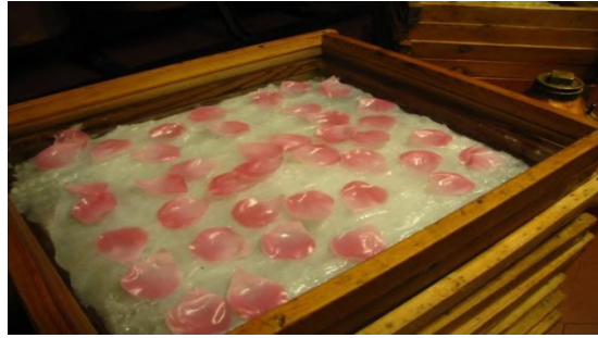
الشكل (21) : صورة لعملية الاستخلاص بالمذيبات العضوية غير طيارة.
