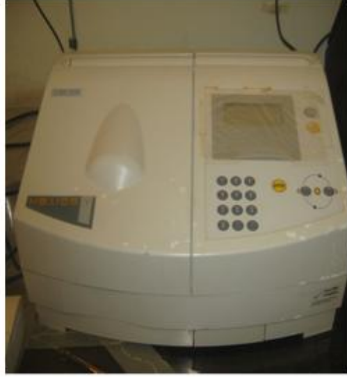
الشكل (39): صورة مقياس الطيف الضوئي المرئي للأشعة فوق البنفسجية.
